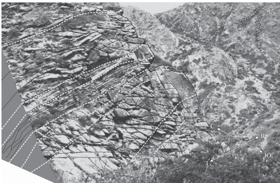
Рис. 8. Характер внутренней тектонической делимости и расслоенности гранитов северного борта хр. Терской-Алатоо (долина ручья Каджи-Сай) в 1.5 км к югу от контакта с отложениями чехла и на глубине 700–800 м от современной кровли массива
